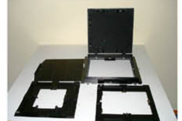
Касета за фотоплаки 300x300 мм с вложки за плаки с по-малък формат.
