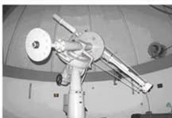
15-см коронарограф, оптичката му схема и кулата за него
