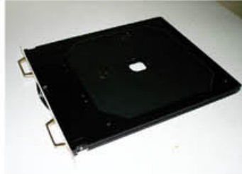
Касета за филтър с размер 300x300 мм. С помощта на разноцветни филтри се осъществява фотометрия на блясъка на звездите в различни дължини на вълната в спектъра им.
