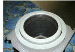
Касети с различен мащаб на получаваните спектри за спектрографа UAGS
