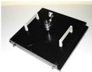
"Нож на Фуко" за визуално фокусиране; поставя се вместо фотоплаката и се фиксира положението на най-рязко изображение на звезда в равнината на фокуса.
