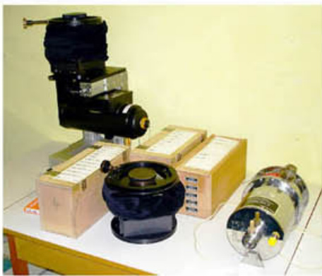
Камери VersArray1300B (вляво горе, с монтиран камерен обектив) и PhotometricsCH260 (вдясно)
