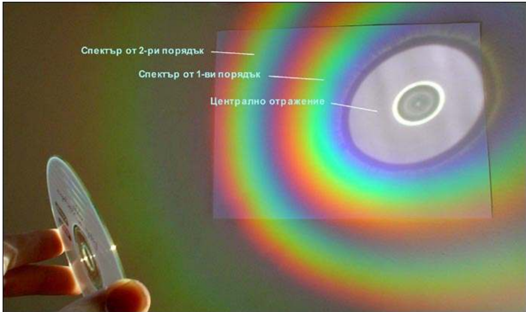
Дисперсия с отражателна дифракционна решетка (пример със CD-диск).
