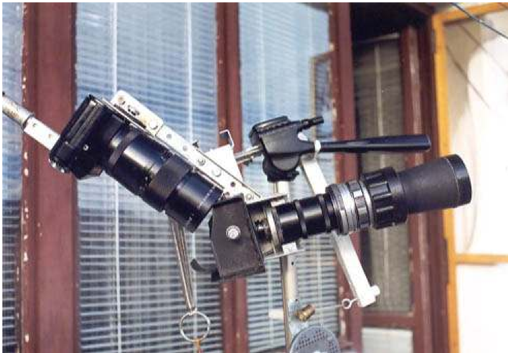
Самоделно конструиран призов спектрограф
